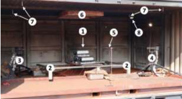
Abbildung 4 Batterieprüfstand für Module und reale Batterien mit 1) Module ausgestattet mit Thermoelementen, 2) Versuchstisch, 3) - 4) Diodenlaser-Spektrometer für HF-Konzentration (Flusssäure), 5) Nahfeld-Thermoelemente, 6) Abzugshaube, 7) Hochdruck-Wassernebelanlage und 8) Kamerasystem, vgl. [9, 16].
