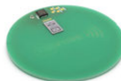
Bild 2 realisiertes RFID-Sensortag mit Stoßsensor
