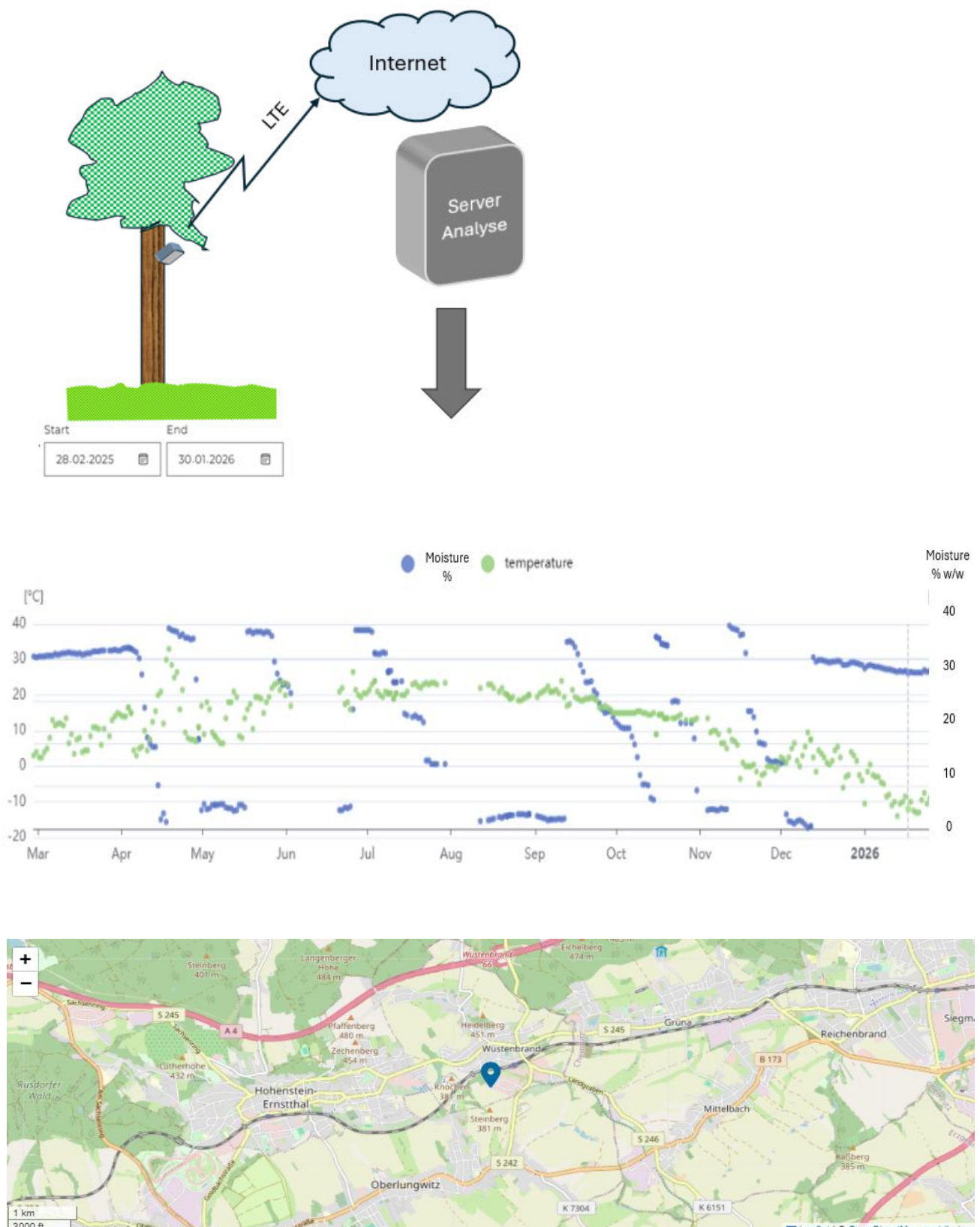
Abbildung 4: vollständige Messkette mit Datenausgabe
