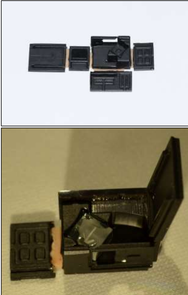
Bild 5 Integration eines Spektrometers mittels Faltmontage (oben unbestücktes Substrat, unten halbgefaltetes System)
