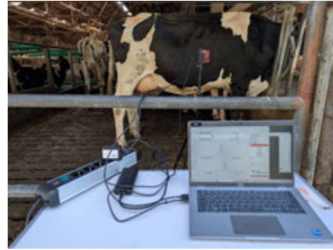
Bild 3: Aufbau zur Messung der Vitalparameter mit dem TI-AWR1642BOOST-Evaluierungsboard
